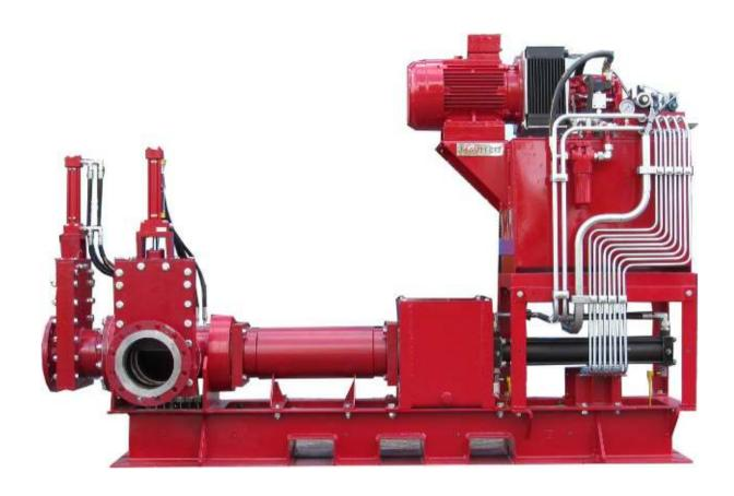
**Функция**: разработан для вязких материалов, таких как производственные отходы, ил, сырье и т.д.
