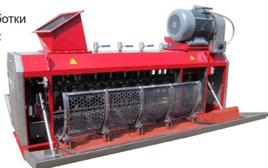
Лопастной распаковщик на колесах: мобильная прокатная единица для тестирования вашего сырья на вашем заводе.
