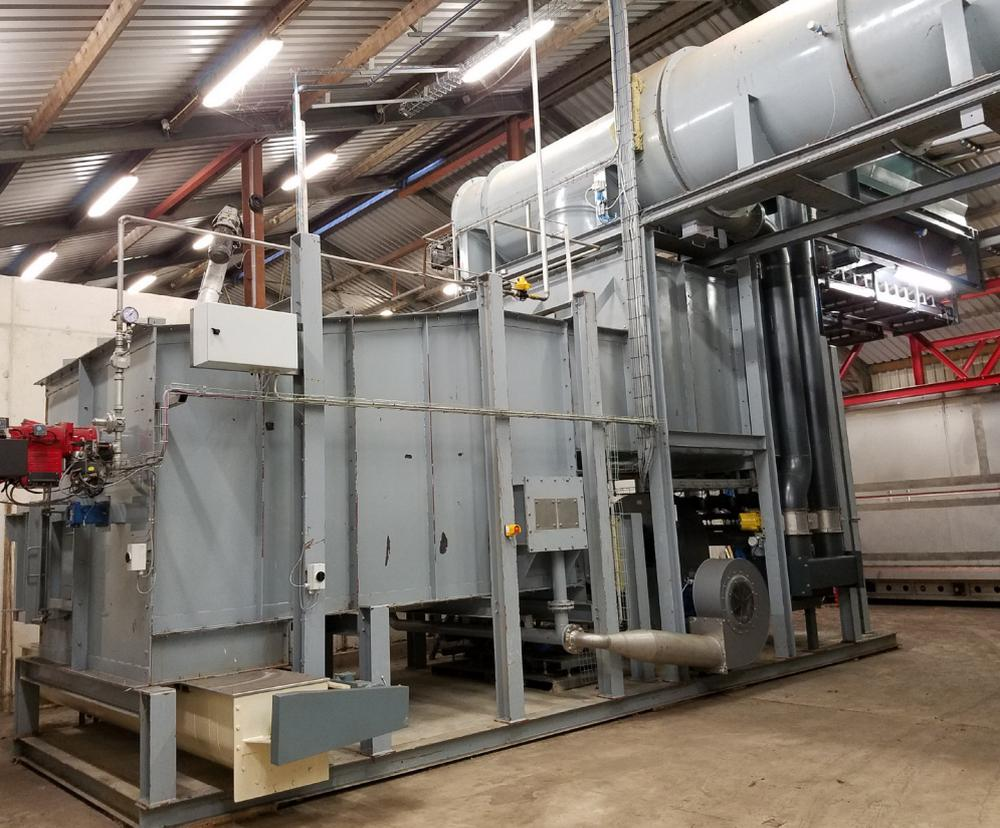
La **GASIFICACIÓN** es una reacción química causada por el material de calentamiento. Además del calor, el gasificador produce EcoChar, un subproducto de alta calidad y muy valioso. El proceso de gasificación asegura una menor huella de carbono ambiental y será una de las respuestas a nuestras futuras necesidades energéticas.
