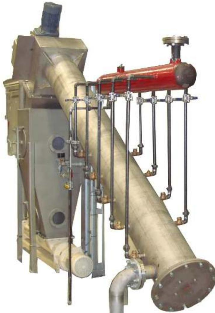
**Función:** Para coagular en continuo un flujo de sangre mediante la inyección de vapor transformándolo en coágulo listo para procesar/secar.
