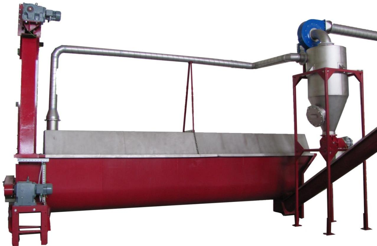
**Функционирование:** Охлаждение горячего продукта из варочного котла или пресса. Продукт охлаждается посредством противоточного воздуха, который втягивается через вращающийся барабан.
